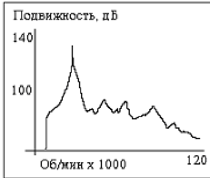
Рис. 5.17. Пример записи собственных частот по всем трем осям.
