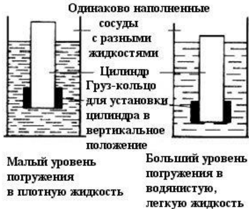
Рис.6.2. Принцип работы и внешний вид обычного ареометра
