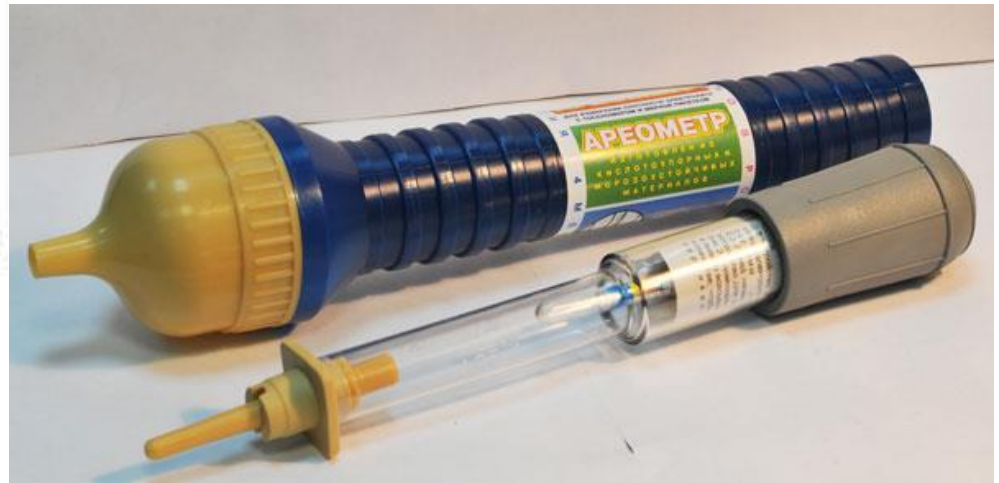
Рис.6.2. Принцип работы и внешний вид обычного ареометра
