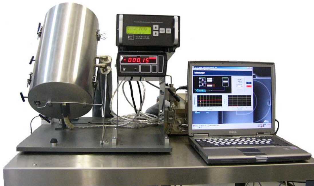
Рис. 6.25. Внешний вид установки для PVT-анализа пластовой нефти, используемой в ООО "ЛУКОЙЛ-Инжиниринг".
