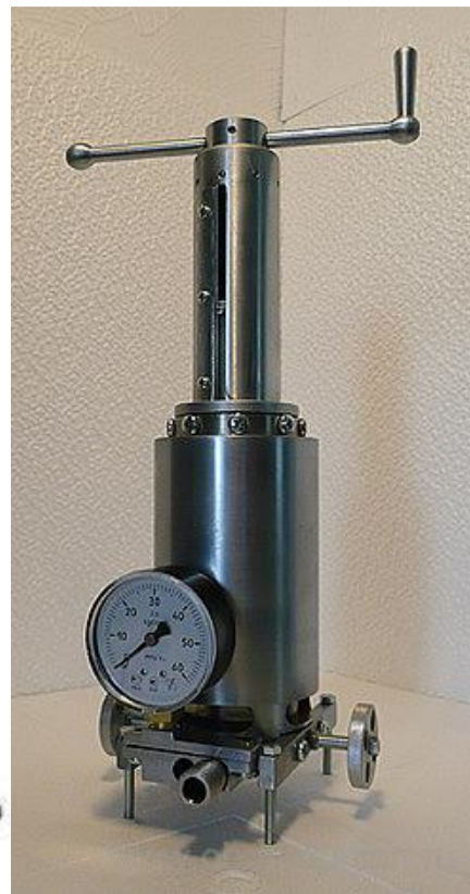
Рис.6.18. Индивидуальный пробоотборник ИП-1.
