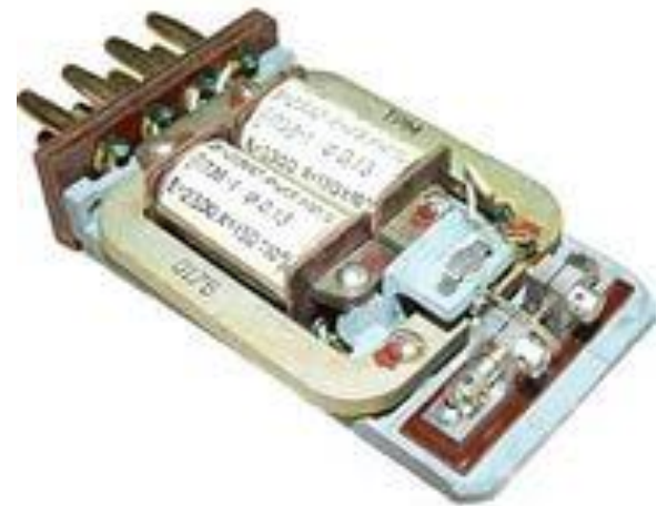
Рис. 7.4. Поляризованное реле с мостовой схемой магнитной цепи.
