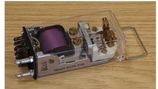
Рис. 7.1. Схема включения реле: X - контролируемая величина; Д - датчик; P - реле; ИУ - исполнительные устройства; K - контакт реле (слева) и внешний вид электромагнитного реле.
