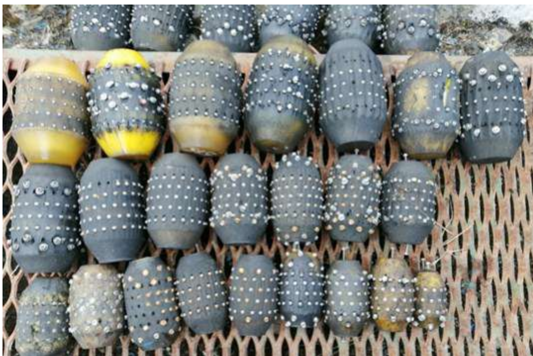
Рисунок 1 – Скреперы, использованные при чистке змеевика печи ПТБ-10 № 2, от 2,75” до 5,75”
