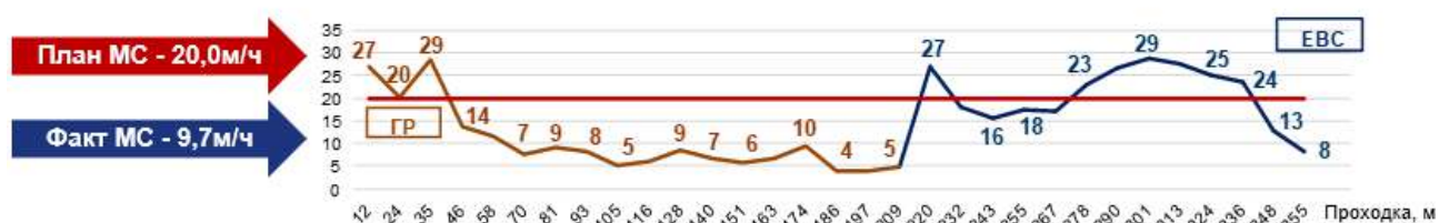
Рисунок 1. Динамика механической скорости (м/ч) при бурении на обсадной колонне кондуктора на скважине №1 Восточно-Сулеевского месторождения
