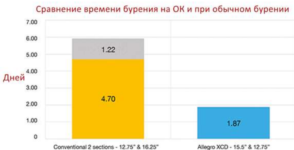
Рисунок 4 – Сравнение временных затрат (слева стандартное бурение двух секций, справа бурение на ОК от «Шлюмберже») показывает сокращение сроков строительства секций в 3 раза
