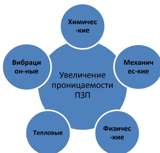
Рисунок 2 – Основные виды методов увеличения проницаемости пород призабойной зоны скважин
