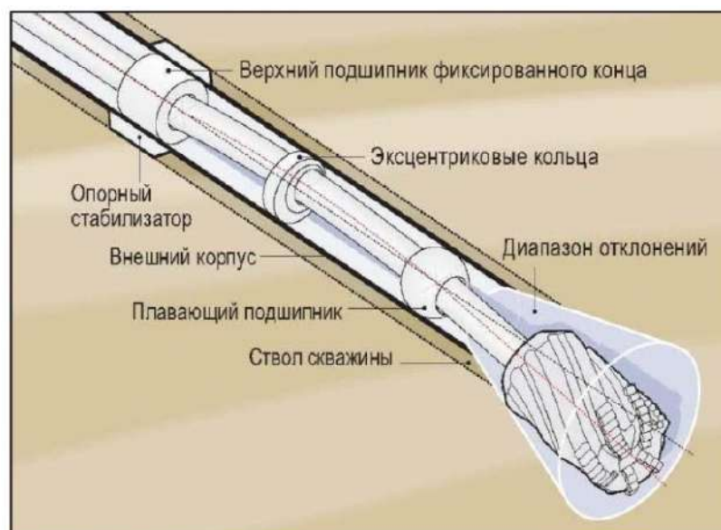
Рисунок 2 – PUS Geo-Pilot 7600 с позиционированием долота («point the bit»)
