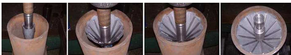
Рисунок 1 – Рабочий механизм цементной корзины
