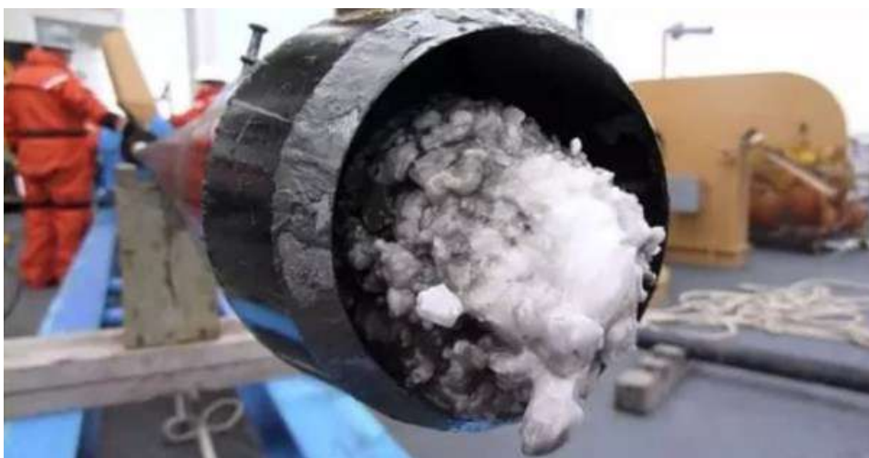
Рисунок 3 - Гидратообразование в трубопроводе
