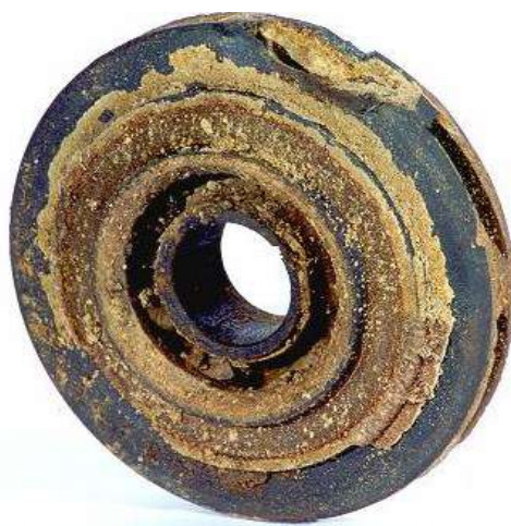
Рисунок 4 – Рабочее колесо, покрытое отложениями
