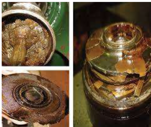
Рисунок 3 – Рабочие колеса и направляющие аппараты ЭЦН, покрытые отложениями солей
