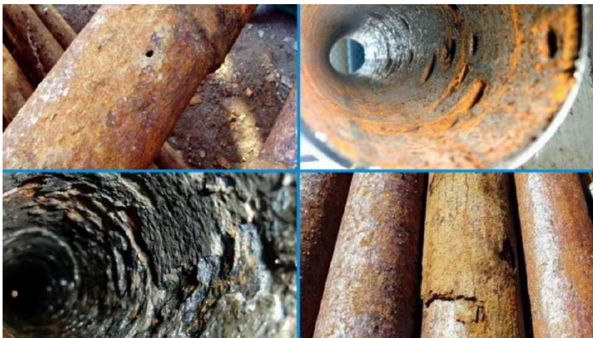
Рисунок 1 – Результат воздействия механических примесей на НКТ
