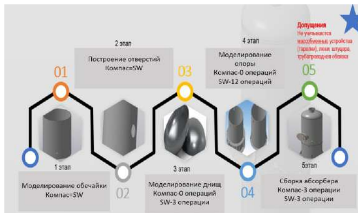
Рисунок 1 - Этапы создания модели абсорбера в средах по компас и по Solidworks
