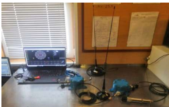
Рисунок 2 – Наземная часть телесистемы LNE
