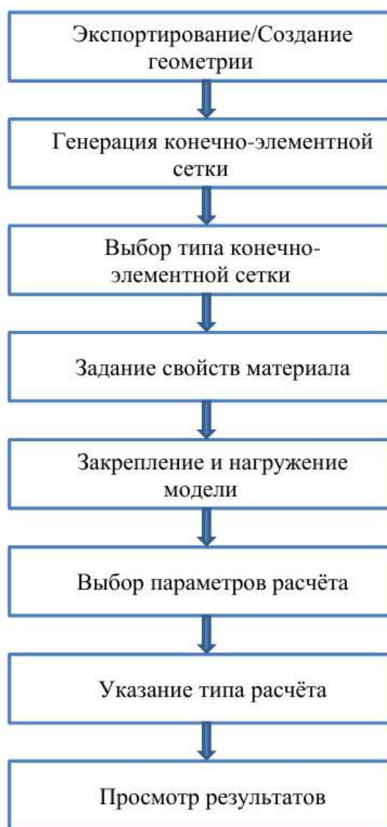
Рисунок 2 – Общая схема последовательности расчетов в программном комплексе «MSC.Marc» [6]
