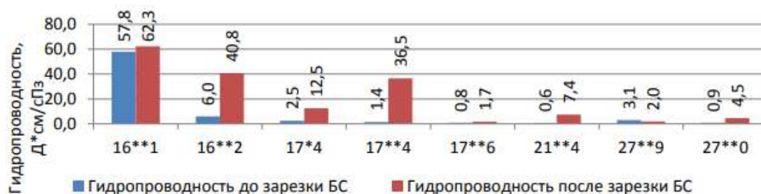
Рисунок 3 – Изменение показателя гидропроводности в скважине
