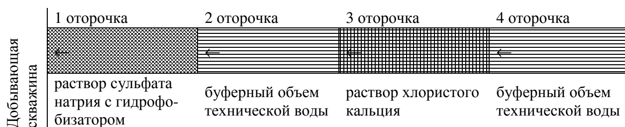
Рисунок 2 — Закачка оторочек осадкообразующей технологии, содержащей сульфат натрия
