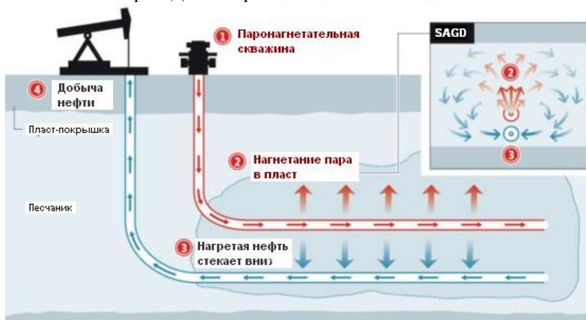
Рисунок 1. Технология добычи тяжелой нефти Steam Assisted Gravity Drainage
