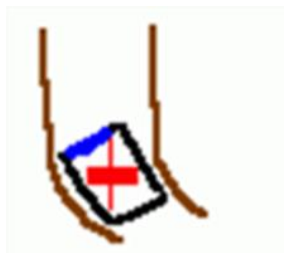
Рисунок 2 –Измерение ровности скважины гироскопическим инклинометром
