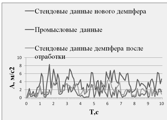
Рисунок 4 - Сравнительный график виброускорений осевых колебаний демпфера на промысле, нового на стенде и отработанного на стенде.
