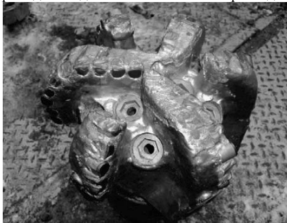
Рисунок 1 – Типичный износ вооружения после разбуривания инструмента обсадной колонны, не адаптированного под PDC долото
