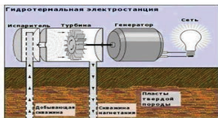
Рисунок 2 - Геотермальные электростанции с бинарным циклом производства электроэнергии.
