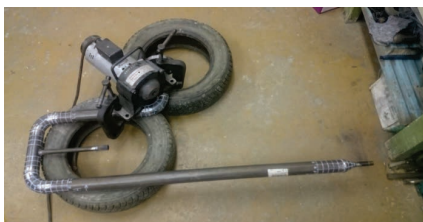
Рисунок - 4 Коллектор с установленным вибровозбудителем «Вепрь-1Г»
