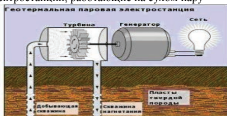
Рисунок 1 - Геотермальные электростанции на парогидротермах
