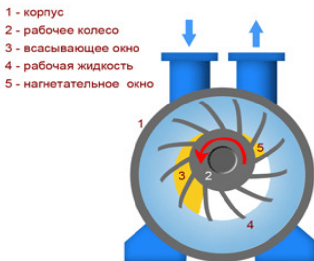
Рисунок 1 – Водокольцевой насос
