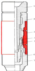
1 - шпиндель; 2 - переводник; 3 - цилиндр; 4 - боек; 5 - поршень; 6 - шток; 7 - нижний переводник
