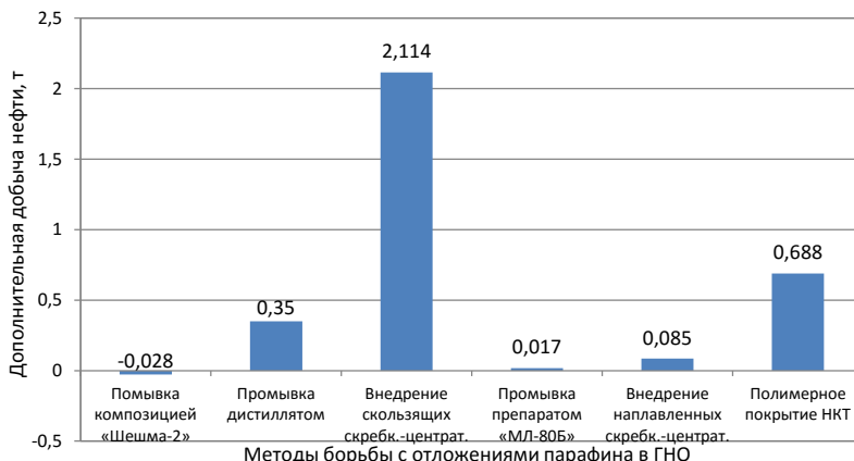
Рисунок 4 – Технологическая эффективность применения методов предотвращения и удаления отложений парафина в условиях Северо-Альметьевской площади
