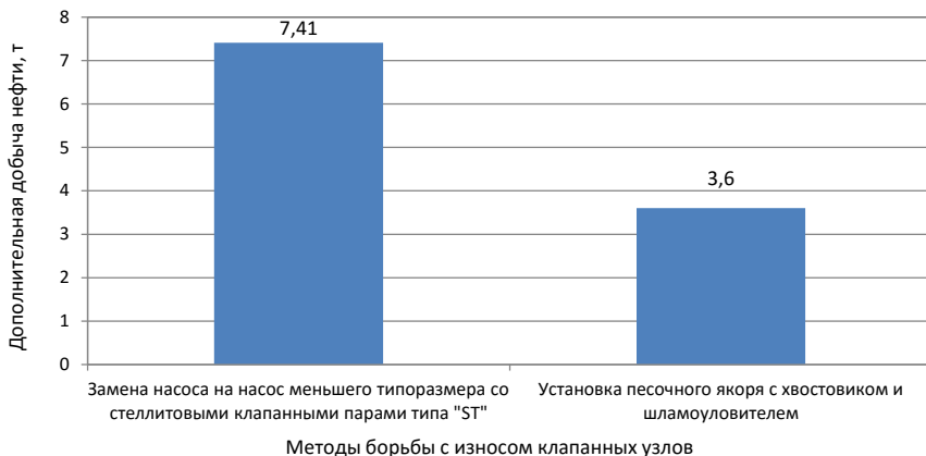
Рисунок 3 – Технологическая эффективность применения методов борьбы с износом клапанных узлов ШСН малодебитных скважин залежи №31
