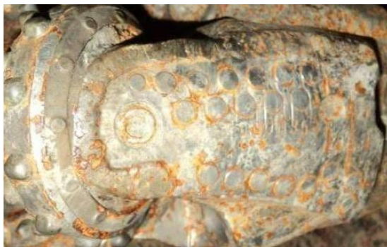
Рисунок 2 – Абразивный износ спинки лапы
