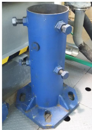
1 – отрезок ОК 324 мм; 2 – плита; 3 – косынка; 4 – болт; 5 – гайка Рисунок 2 – Оснастка для крепления образцов и инструмента
