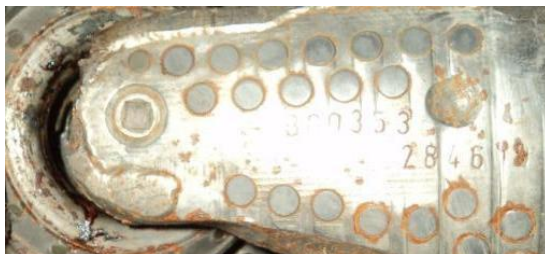
Рисунок 1 – Ударный износ спинки лапы
