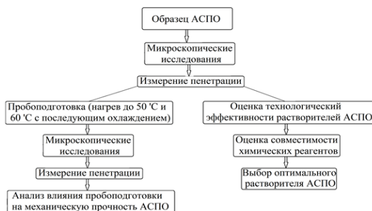
Рисунок 5 - Схема комплексной оценки эффективности растворителей АСПО с учетом последовательного применения химических реагентов
