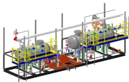
Рис. 1 – Сепарационная установка для сепарации нефти с высоким газовым фактором
