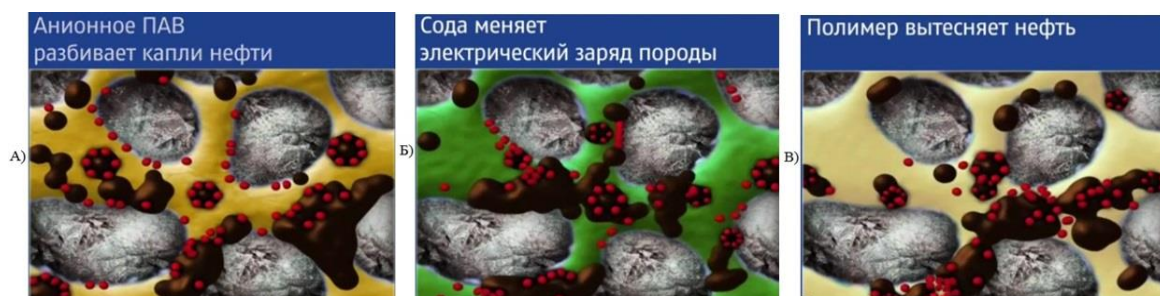
Рис. 3 – Механизм воздействия АСП заводнения: а – анионное ПАВ, б – щелочь, в – полимер
