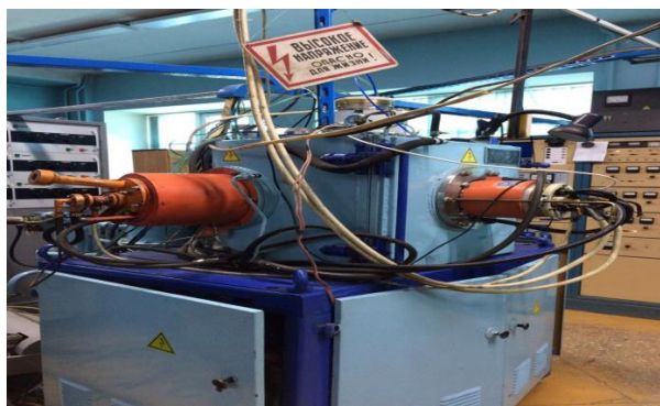
Рис. 1 – Модернизированная установка ННВ-6,6-И1, используемая для диффузионного напыления
