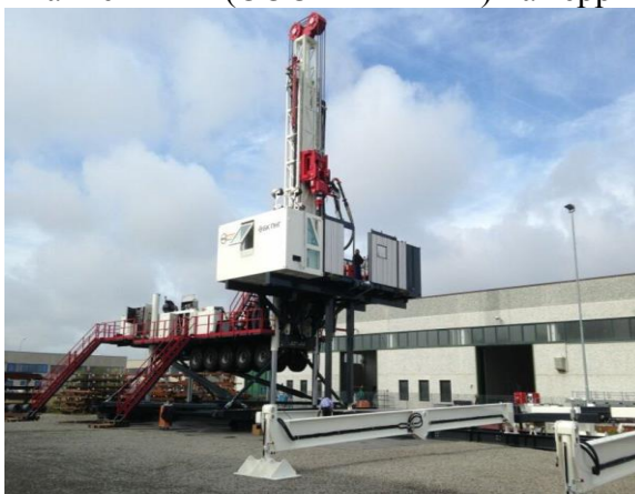
Рис. 1 – Мобильная гидравлическая буровая установка «Эскимос 4500 ВЕИ ДС 250»
