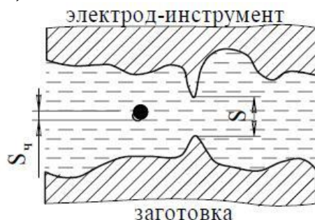
Рис. 1 – Межэлектродный промежуток с расположенными токопроводящими частицами.
