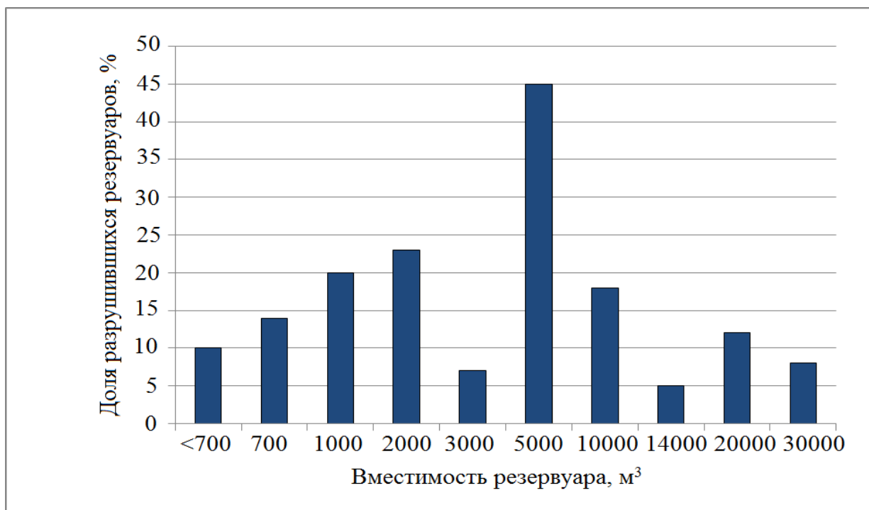
Рис. 1 – Относительное распределение разрушившихся резервуаров по вместимости
