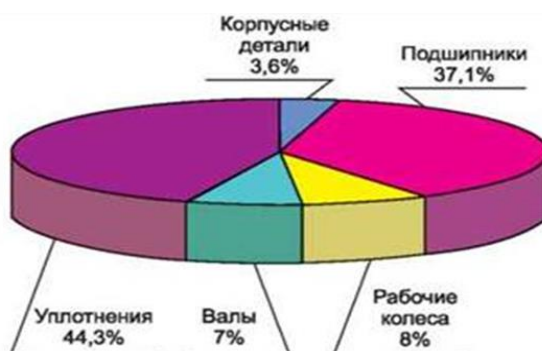
Рис. 2 - Диаграмма распределения повреждений насосов
