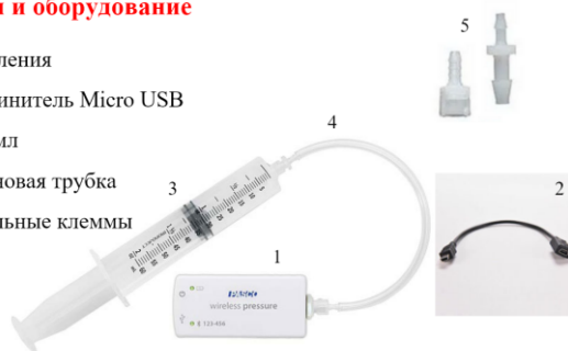
Рисунок 4 – Датчики и комплектующие Pasco используемые в данной работе
