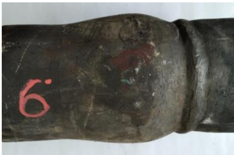
Рисунок 2 – Отдулина в трубе змеевика [5]
