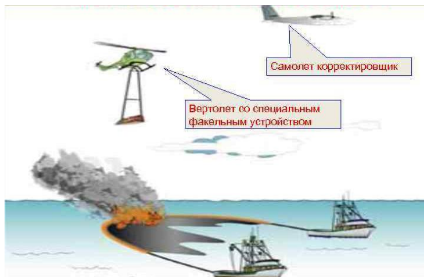
Рисунок 5 – Сжигание нефтяного пятна на месте разлива
