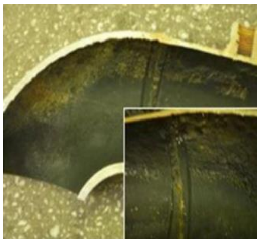
Рисунок 4 – Износ труб по внутренней поверхности [5]
