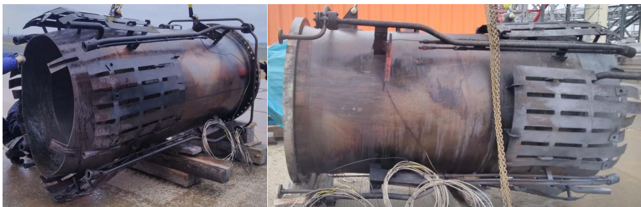
Рисунок 2 – Деформированный факельный оголовок
