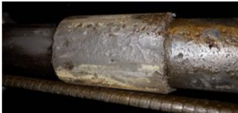
Рисунок 1 - Сероводородная коррозия НКТ
