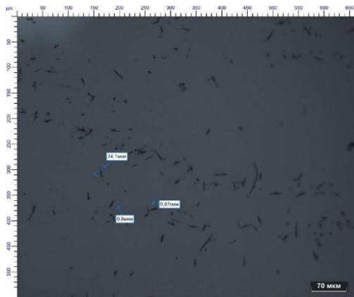
Рисунок 2 – Структура магнитного порошка «Дианк-36»
