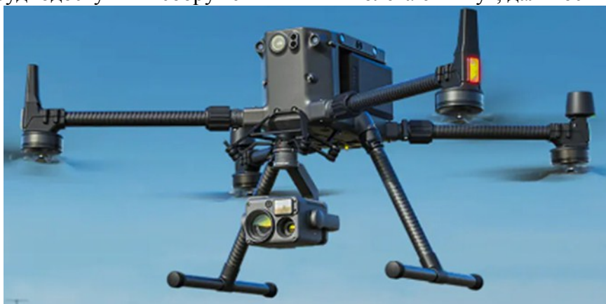
Рисунок 9 – Коптер для видеосъемки. Оснащён камерами высокого разрешения, способными зафиксировать малейшие отклонения от стандартной работы трубопровода, кроме того, применяется подвесное оборудование, ведущее съёмку в тепловом диапазоне и газоанализаторы.
