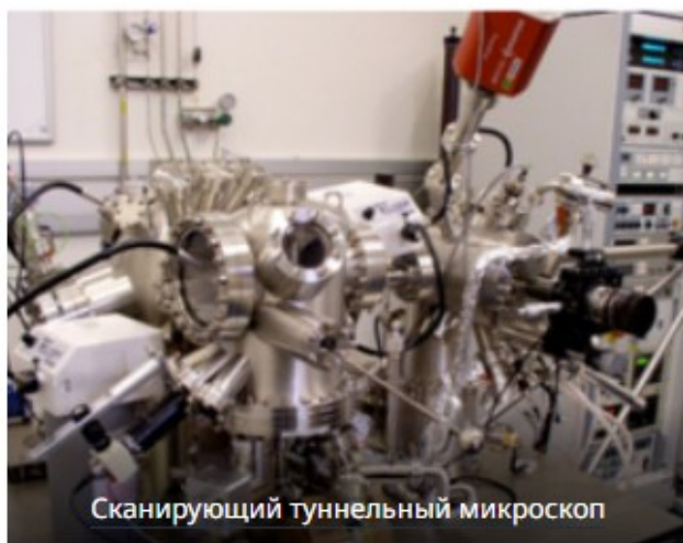
Рисунок 2 - Сканирующий туннельный микроскоп; схема работы СТМ
