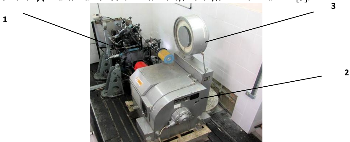
1 – дизель Д-245.12С; 2 – динамометрическая машина; 3 – весовое устройство
