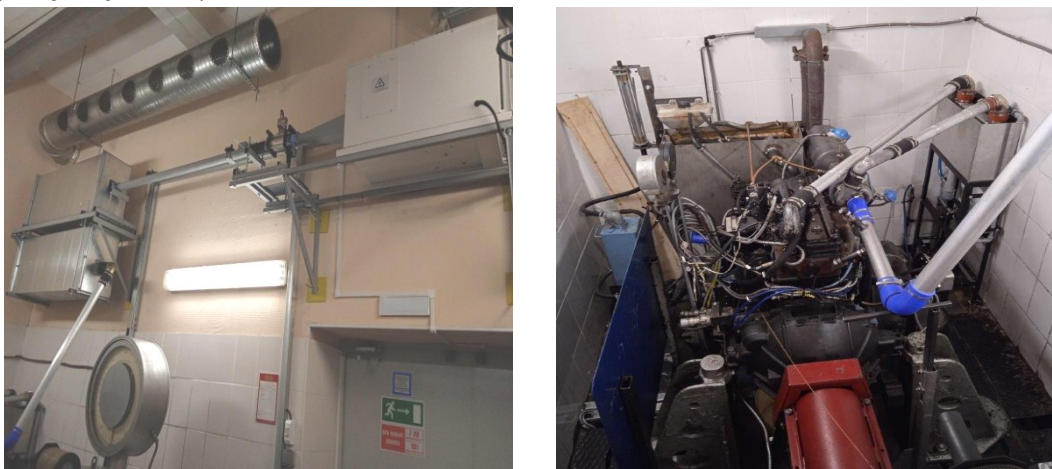
Рисунок 4. Общий вид модернизированного моторного стенда Д-245 под требования метода комплексной оценки эксплуатационных свойств моторных масел
