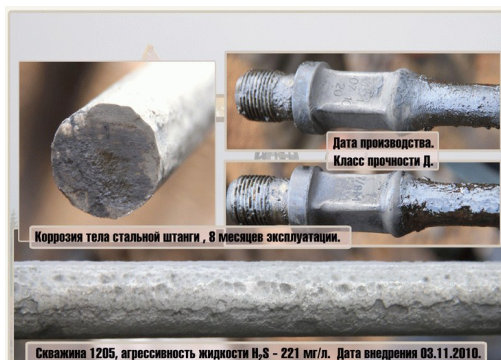
Рис. 1. Результаты влияния коррозии на нефтепромысловое оборудование
