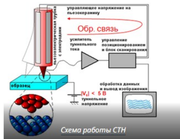
Рисунок 2 - Сканирующий туннельный микроскоп; схема работы СТМ
