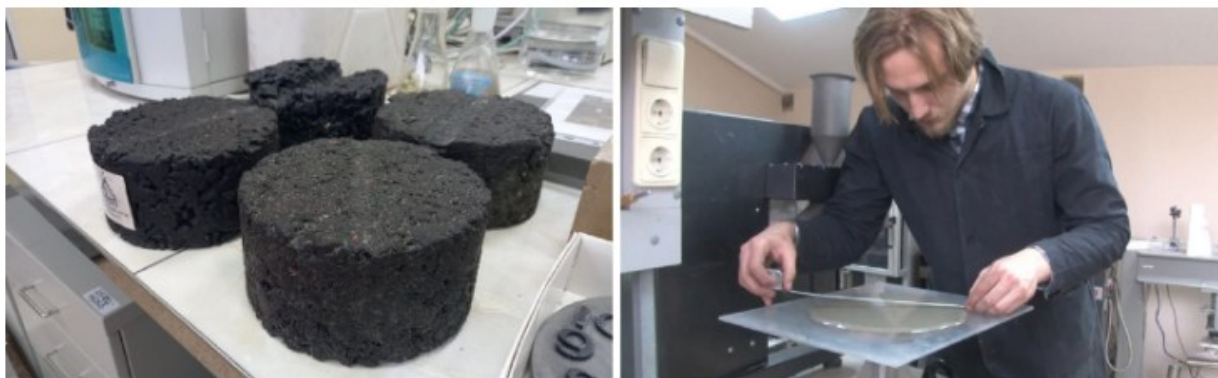
Рисунок 10 – От наночастицы к созданию «умного» асфальта. Сотрудники центра «Наноматериалы и нанотехнологии» НИУ МСГУ разработали самовосстанавливающийся асфальтобетон с капсулированным полимерным модификатором, который позволяет самостоятельно «залечивать» трещины в дорожном покрытии с упрочнением прочности от 20 до 40%. Аналогов нет [4].
