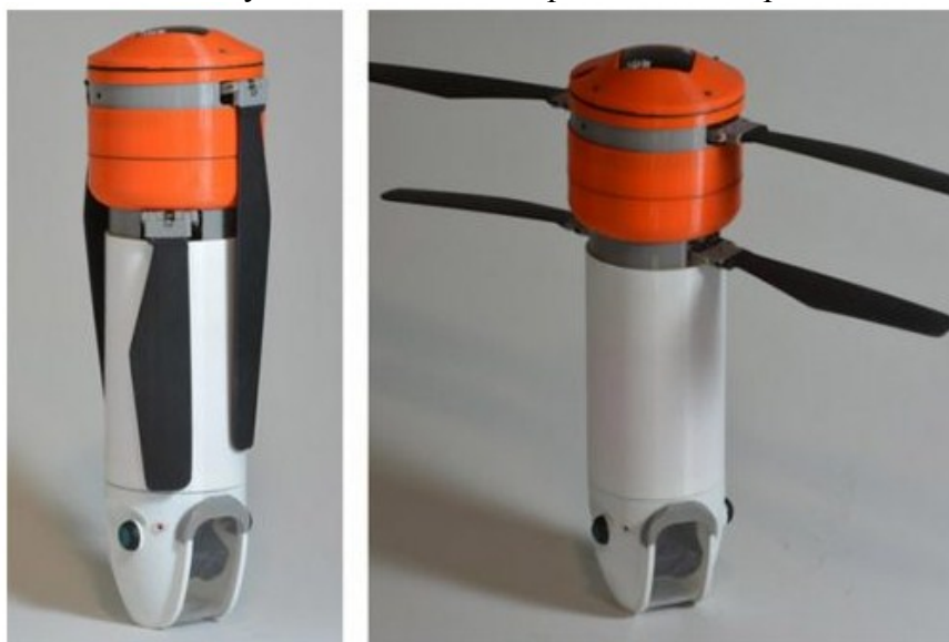
Рисунок 4 - Дрон-бутылка с отличной маневренностью, предназначена для мониторинга и поисково-спасательных операций
