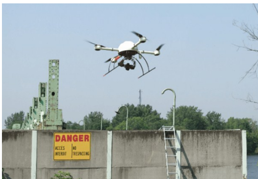
Рисунок 7 – Инспекция загрязненных, опасных и труднодоступных сооружений
