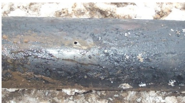
Рисунок 3. Свищи на поверхности трубопровода
