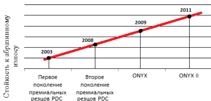
Рисунок 1 – Износостойкость и термическая стойкость резцов
