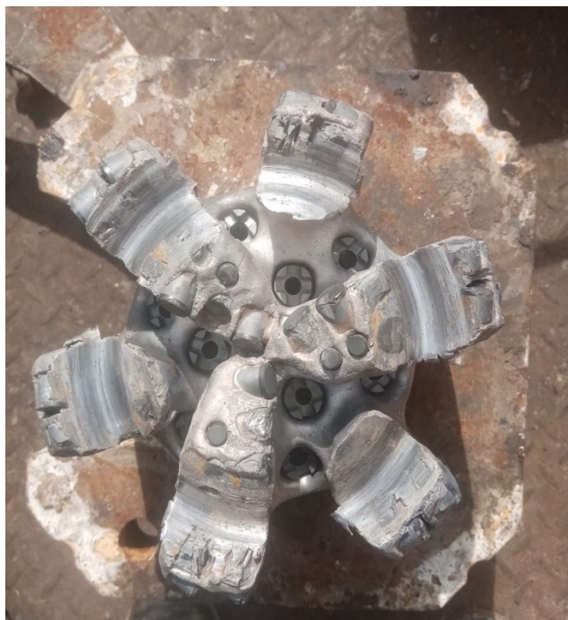
Рис. 2. Долото с высоким износом и кольцевой выработкой.
