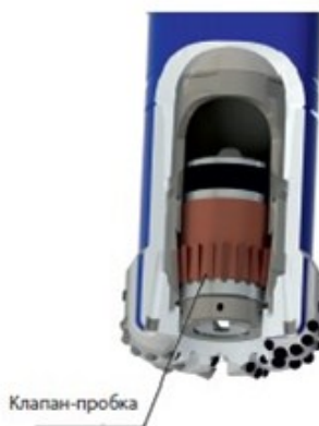
Рисунок 3 – Клапанная система защиты керна от шлама и бурового раствора
