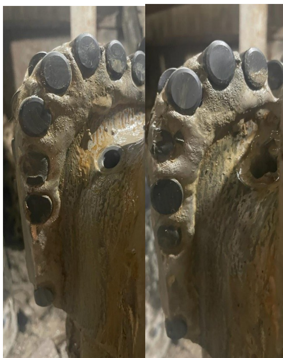
Рис. 1. Пример износа долота при разбуривании тех.оснастки.
