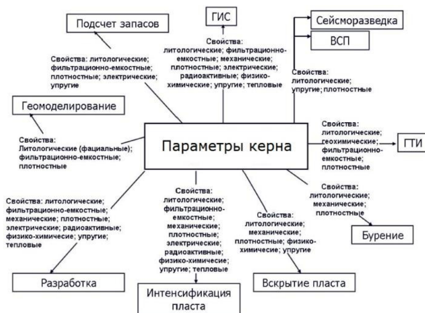
Рисунок 1 – Применение петрофизических параметров в различных направлениях нефтегазовой отрасли
