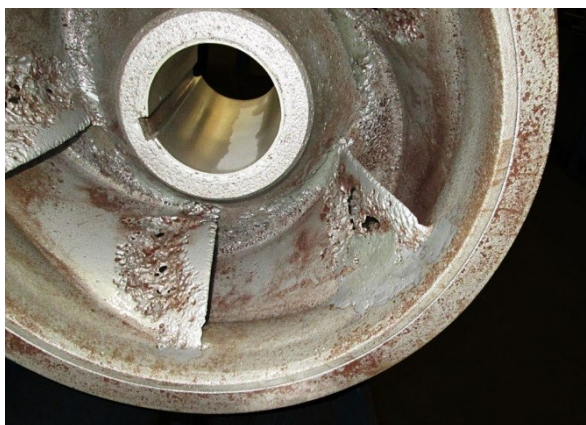
Рисунок 2 - Повреждения нанесенные процессом кавитации
