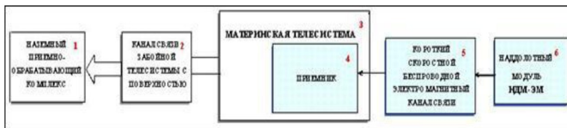
Рисунок 1 – Структурная схема телесистемы с наддолотным модулем
