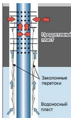
Рисунок 1 - Заколонный переток в цементном камне
