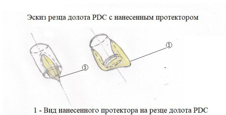
Рис. 4. Эскиз резца долота PDC с нанесенным протектором (выделенны желтым)
