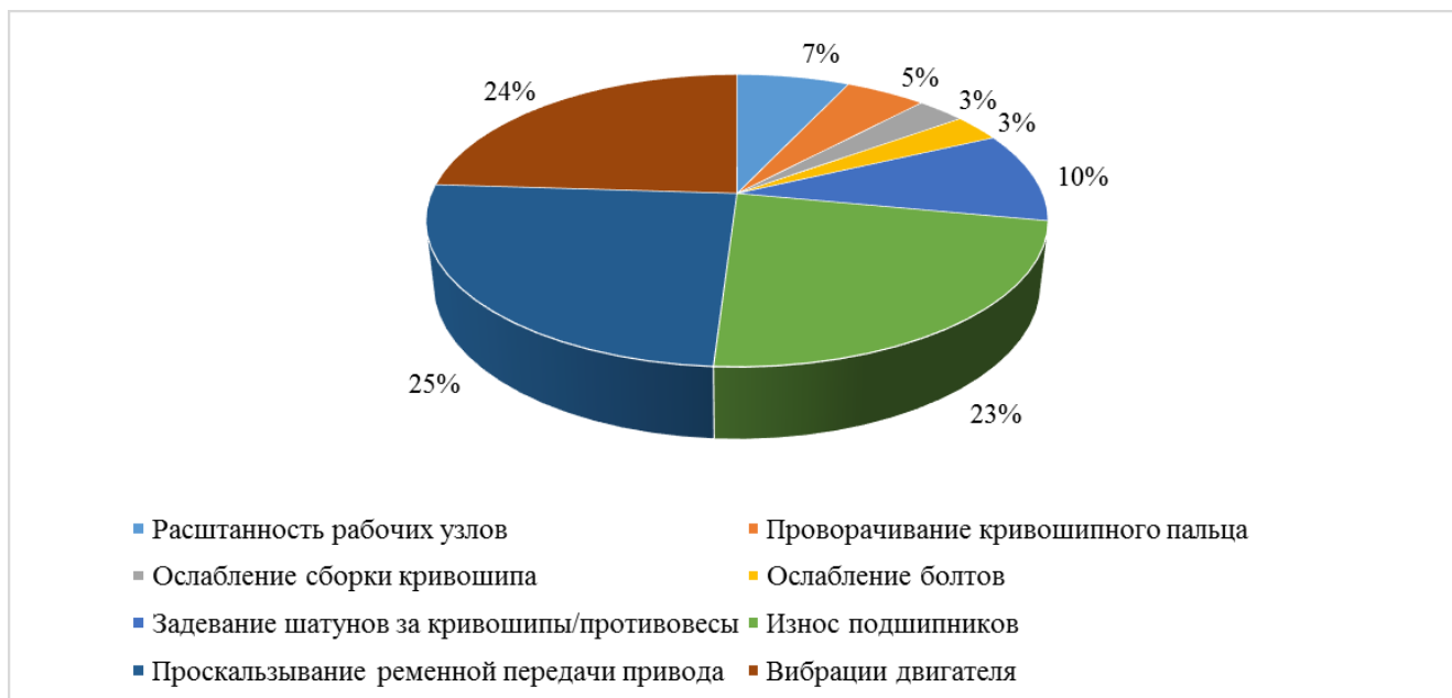
Рисунок 1 – Процентное распределение неполадок в работе наземного оборудования при эксплуатации скважинной штанговой насосной установки на месторождениях Урало-Поволжья
